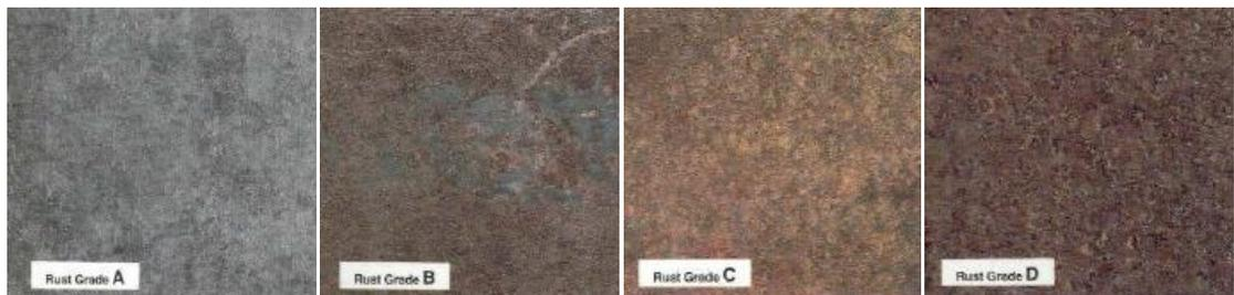
La limpieza se expresa pues en “grado de limpieza de un estado de superficie inicial” Ejemplo: para un grado de limpieza Sa 2 ½ en una chapa de acero de estado de superficie inicial grado C la denominación sería “C Sa 2 ½”
