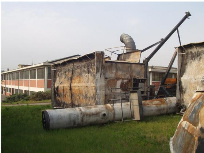
*Figura 1 - Colectores de polvo después de una explosión catastrófica*
