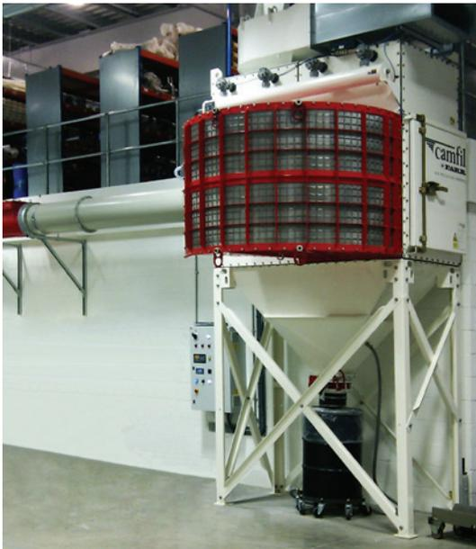
Figura 4 - Un colector de polvo con un supresor de llamas
