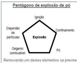
Removendo um destes elementos se previne a geração de uma explosão, mas não necessariamente a de um incêndio
