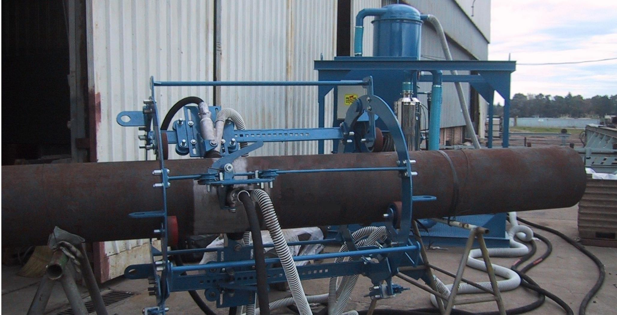
A Cym Materiales fabrica equipamentos de jateamento portáteis em circuito fechado modelo CY-VAC para o **jateamento de superfícies** metálicas, madeiras, concreto etc.
