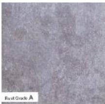
**Grado A** Superficie de acero con la capa de laminación intacta en toda la superficie y prácticamente sin corrosión.
