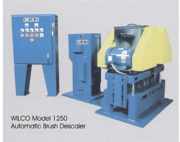
La combinación del equipo de quebrador más el equipo Cepillado automático de alambres WILCO permite al cliente decapar alambre de alta calidad y de condiciones variadas, incluso con altos porcentajes de óxido o cascarillas secundarias en la superficie del mismo.
