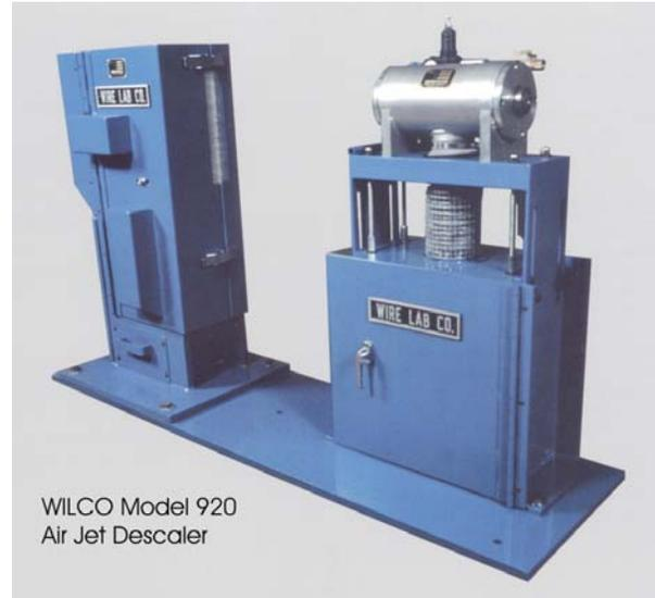
El sistema de decapado mecánico 920 de WILCO está diseñado para procesar barras de acero de bajo a alto contenido de carbono hasta 12,7mm de diámetro. Los bajos costos operativos hacen al Modelo 920 apto para la producción de alambres de calidad industrial donde el énfasis está puesto en el costo.
