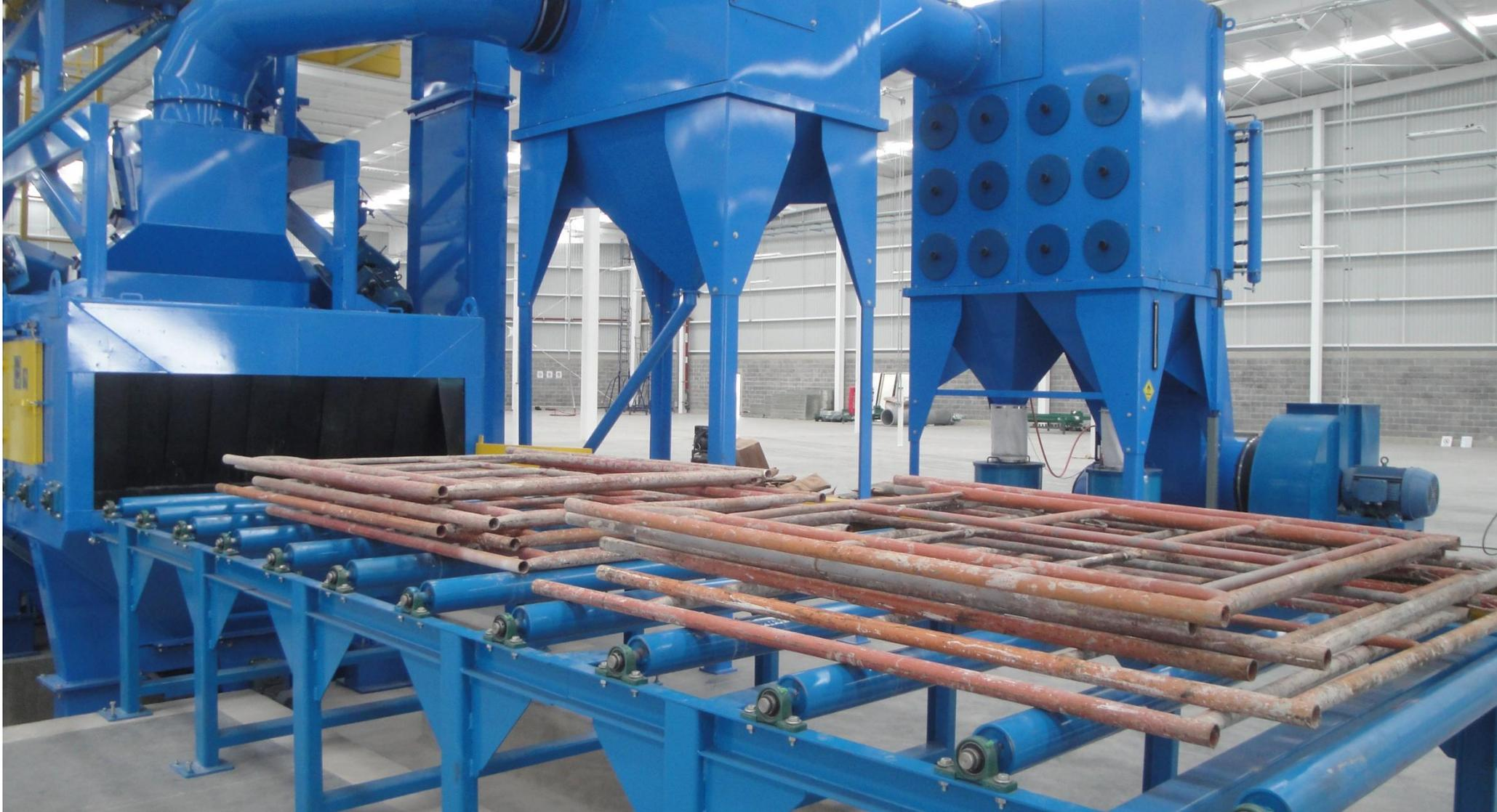
Cym Materiales SA fabrica equipos de **granallado automático** de pasaje continuo y cuartos de granallado manual para la **limpieza de andamios tubulares, encofrados metálicos, tablonés, riendas, pasarelas, escaleras, puntales** y sus correspondientes accesorios adaptándose a las necesidades de cada cliente.
