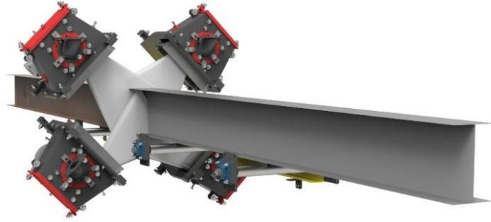
Las máquinas granalladoras pueden utilizar una o múltiples turbinas posicionadas de modo que el abrasivo llegue a toda la superficie de las piezas a granallar. El número de turbinas montadas en una máquina queda determinado por la forma y tamaño de las piezas a limpiar.
