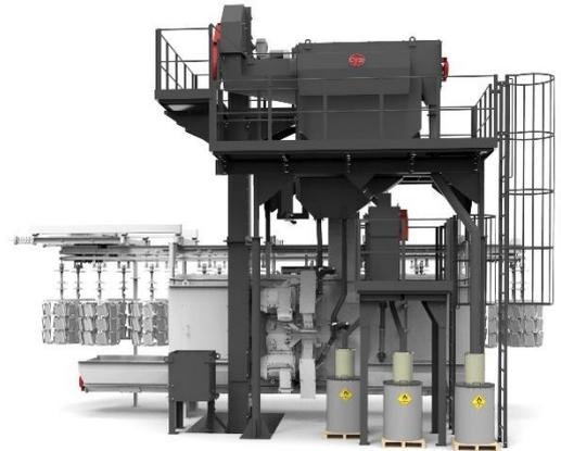
Una combinación de zarandas y chapas deflectores, y el flujo de aire a través de la cortina de granalla, separan las partículas contaminantes, polvos y partículas de abrasivo pequeñas que dejan de ser efectivas en el granallado. El abrasivo limpio cae en una tolva superior desde donde es alimentado por gravedad a la turbina.
